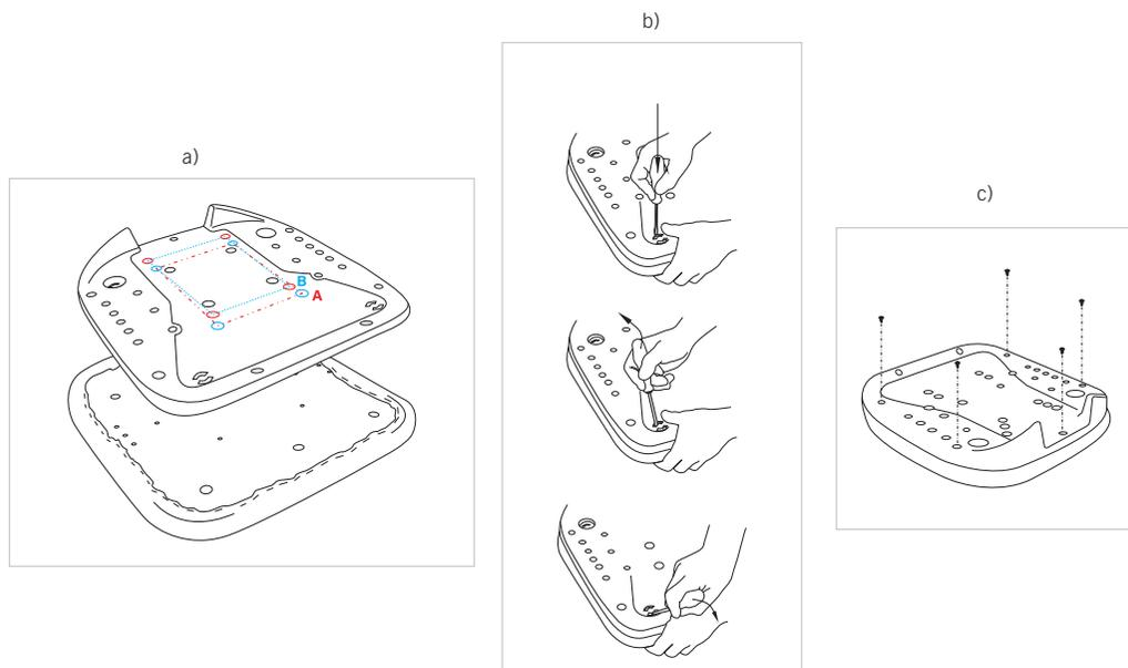
**Passo 02:** Fixar o mecanismo (item 5) sobre o conjunto do assento montado posição **A**, no passo 01, com 4 calços (item e), 4 arruelas (item c) e 4 parafusos (item b).
