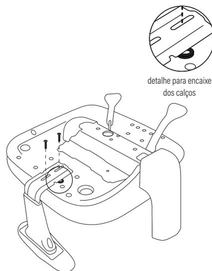
detalhe para encaixe dos calços
