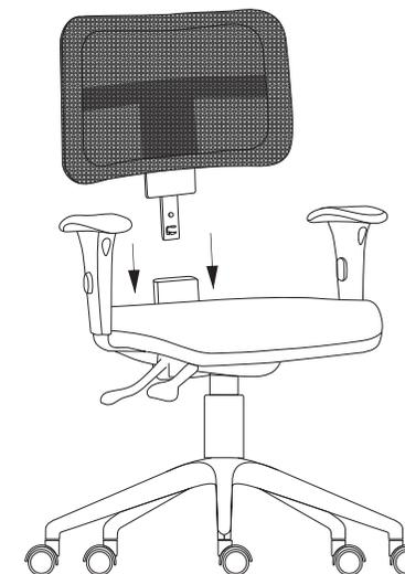
Como boa prática de montagem, recomendamos que na fixação de parafusos em roscas metálicas, seja utilizado trava química. Este cuidado evita que o parafuso se solte prematuramente.
