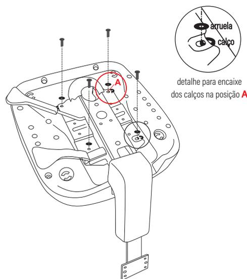
detalhe para encaixe dos calços na posição **A**
