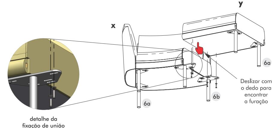
**União de Módulo a Mesa:** Para união de uma mesa a qualquer módulo (01, 02, 03 e 04), os pés desses módulos devem ser fixados anteriormente.
