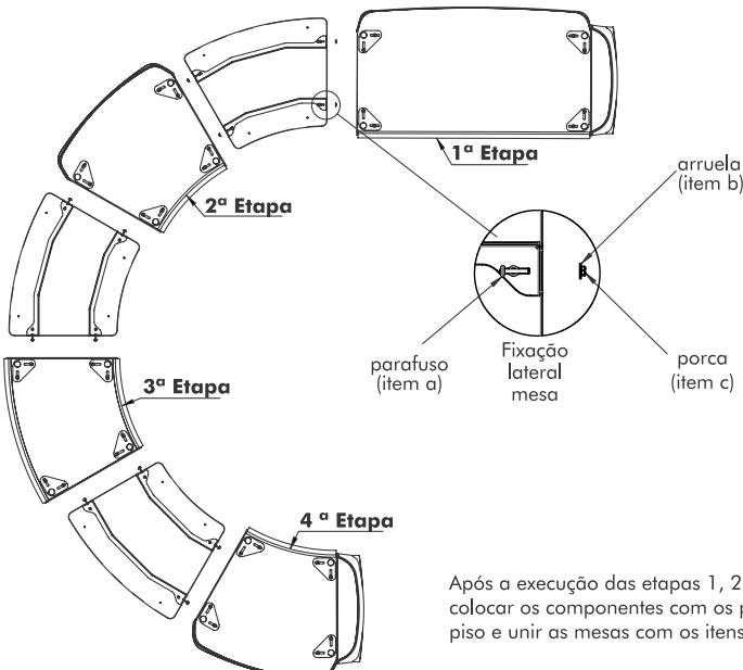
Como boa prática de montagem, recomendamos que na fixação de parafusos em roscas metálicas, seja utilizado trava química, (não fornecida). Este cuidado evita que o parafuso se solte prematuramente.
