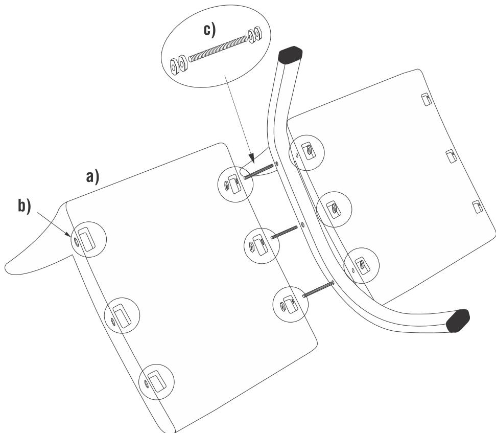
**Passo 02:** Após fixar o pé intermediário no passo 01, fixar os pés laterais (item 2). Verificar procedimento conforme ilustrado e utilizar 3 parafusos (item b) e 3 porcas (item c) para cada lateral.
