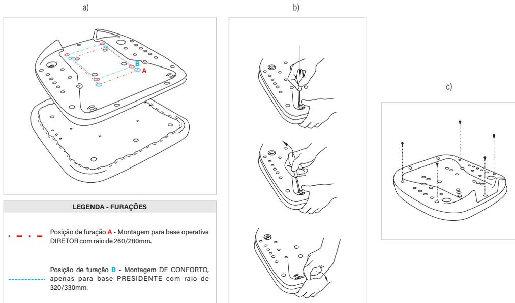
**Passo 02:** Fixar o mecanismo (item 5) sobre o conjunto do assento montado no passo 01, com 4 calços (item e), 4 arruelas (item c) e 4 parafusos (item b).
