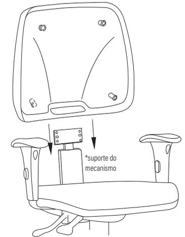
**Passo 06:** Encaixar e parafusar o conjunto do encosto (item 02), no \*suporte do mecanismo de encosto, a partir da \*2ª posição da furação do conjunto, conforme ilustrado. Utilizar 4 parafusos (item f) para fixar.
