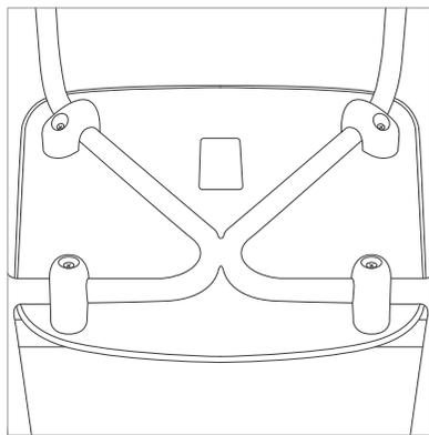
**Passo 04:** Encaixar os tapa tubos (item 04) na parte superior da estrutura (item 06), com inclinação voltada para frente (parte maior para trás).
