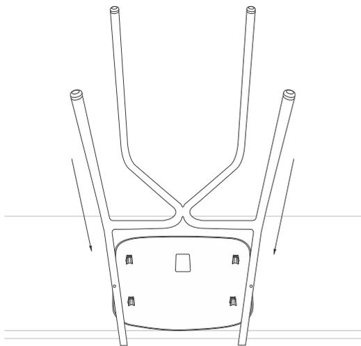
**Passo 03:** Encaixar os acabamentos (item 03), de acordo com as numerações indicadas em cada peça que estão relacionadas no assento. Em seguida fixar com parafusos (item b), conforme ilustração.
