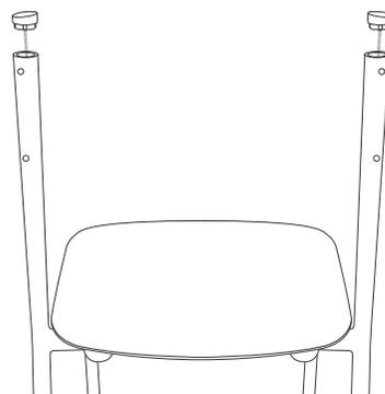
**Passo 05:** Encaixar os plugs do encosto (item 01) na estrutura (item 06), exercer pressão para estabilizar e fixar com parafusos (item a).
